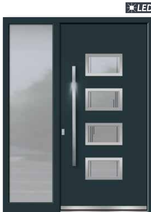
LÖCKNITZ E flügelüberdeckendes Türblatt, Haustür Glas „Lindos“, Klarglas mit Teilmattierung, Seitenteil Glas „Bonn“, vollflächige Mattierung, außen Edelstahlrahmen, innen ohne Rahmen, Griff Marek 1200 mm mit LED-Beleuchtung, planflächiger Edelstahl-Trittschutz 40 mm
