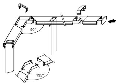
Handlaufecke mit Handlauf-Eckverbindung
