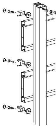
Bauseitiger Pfosten mit aufgesetzem senkrechten Montagegurt für Klemmbefestigung\* roma
