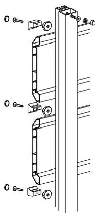
Bauseitiger Pfosten mit aufgesetzem senkrechten Montagegurt für Klemmbefestigung\* milano
