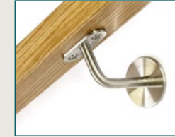
Modell 02 mit gewölbter und gerader Platte, 1-Punkt-Befestigung (Stockschraube), in Edelstahl und pulverbeschichtet erhältlich
