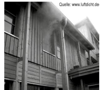
Abb. 1 Blower-Door-Prüfverfahren mit Unterdruck...
