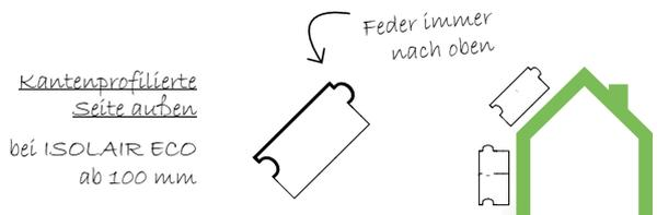
Abb.4 Profilierung ISOLAIR ECO ab 100mm
