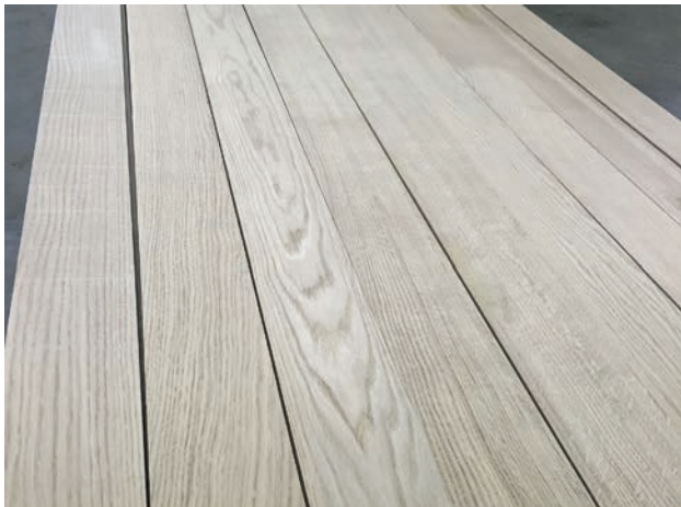
sorgfältig vor der Verleimung selektierte Lamellen
