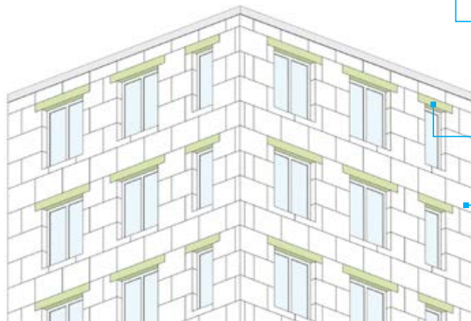
Brandschutzriegel über jeder Öffnung
