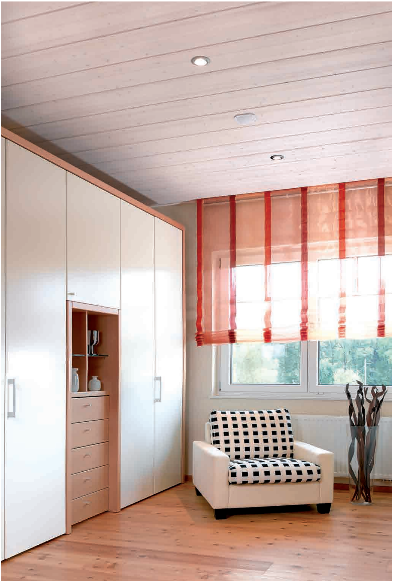
Fichte-Langpaneele – Fase – Oberfläche gebürstet – edelweiß Landhausdielen Lärche – Mehrblatt – Oberfläche glatt – geölt und gewachst
