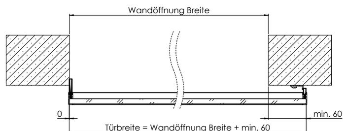
**HINWEIS** Technisch bedingt hat PLANE0 AIR SILENT einen maximalen Abstand von 4,5 mm von der Wand. Abstandsets für z.B. Montage vor Sockelleisten sind separat erhältlich.
