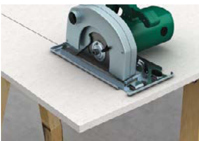
Sägen mit Handkreissäge (Drehzahl regulierbar)
