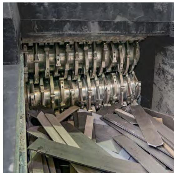
Ausgediente Terrassendielen, die über die Rücknahme-händler an uns zurückgegeben werden, schreddern wir – sortenrein getrennt – zu feinem Granulat. Dieses wird in den Produktionskreislauf zurückgeführt und für die Herstellung neuer Dielen verwendet, wodurch wertvolle Ressourcen eingespart werden können.
