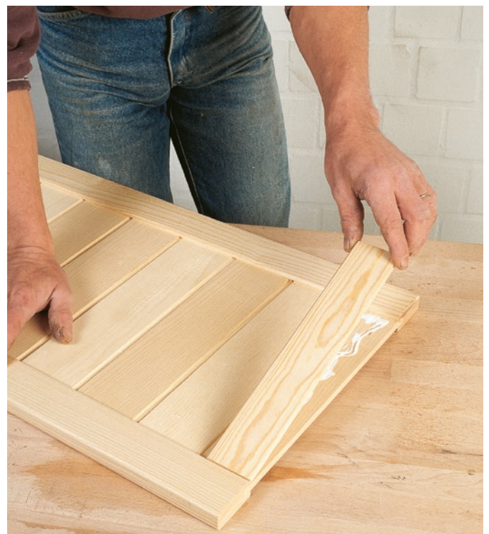
Möbelzuschneidetüren: Anleimen der Rahmenabschlussleiste
