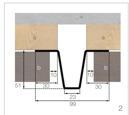
a= Unterkonstruktion, b= Fassadenholz
