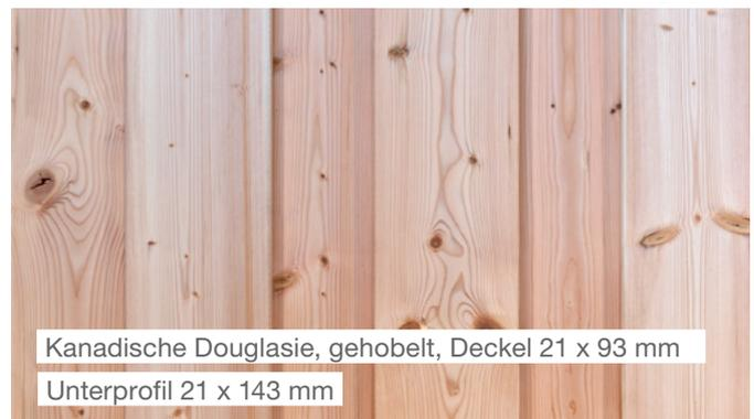
Kanadische Douglasie, gehobelt, Deckel 21 x 93 mm Unterprofil 21 x 143 mm
