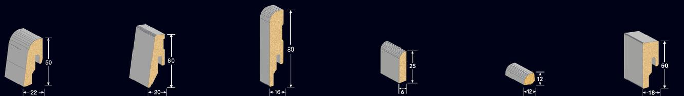
Fußleiste Profil 2 PK      Fußleiste Profil 3 PK      Fußleiste Profil 5 PK      Fußleiste Profil 6      Viertelstab Profil 7      Fußleiste Profil 8 PK
