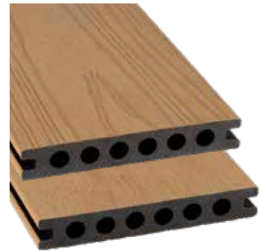
Terrassendiele BPC Primo Rundhohlkammer, co-extrudiert, Eiche, L 4.000/5.000 x B 136 x S 21,5 mm
