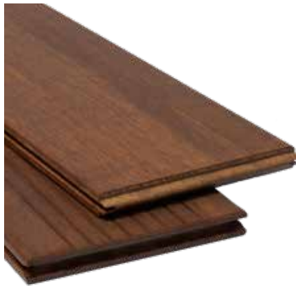
Terrassendiele Bambus mineralveredelt fein genutet/glatt, vorgeölt, stirnseitig Nut & Feder, L 1.850 x B 178 x S 20 mm
