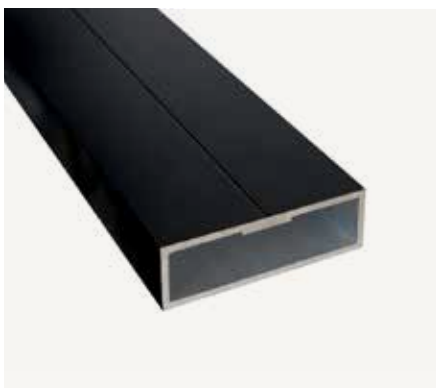
Alu-Unterkonstruktion System 20 / 60, Farbe: Schwarz, 3 / 2 mm Wandstärke, endlos verbindbar, Maße: 20 x 60 mm, Längen: 2 / 4 m
