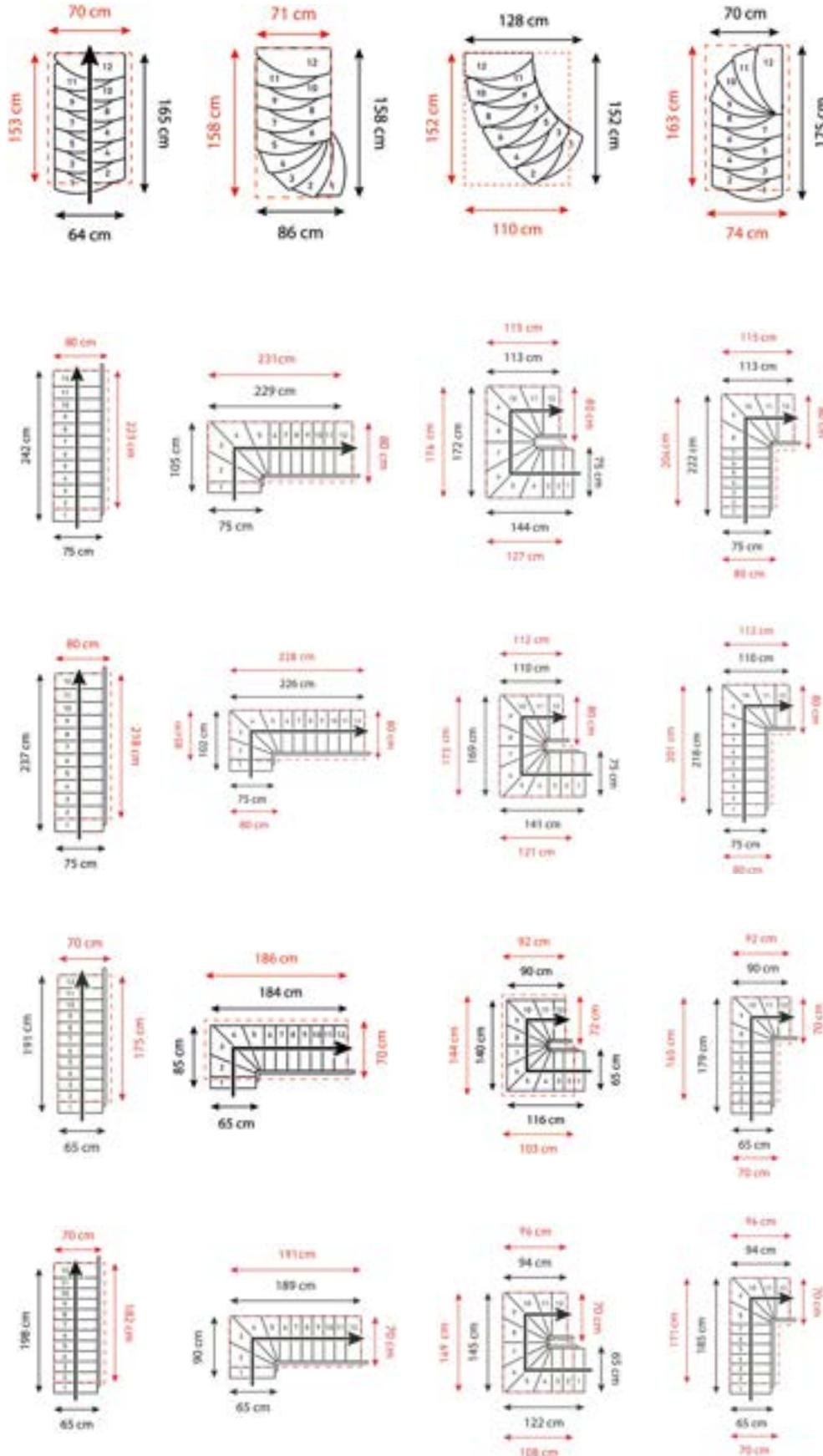
**Beispiel 12-stufige Berlin/Basel, Treppenbreite 64 cm:** Kommt eine Stufe hinzu, verändert sich die Ausladung und Sie addieren 13 cm. Entfällt eine Stufe, ziehen Sie entsprechend 13 cm von der Ausladung ab.
