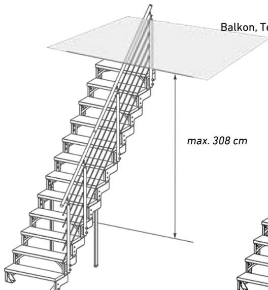
Abbildung 2: 2-14 Stufen/15 Steigungen
