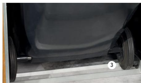
Am Boden verhindert die Rollenführung (3), dass die mitunter schwere Tonne beim Kippen nicht nach hinten wegrollen kann.
