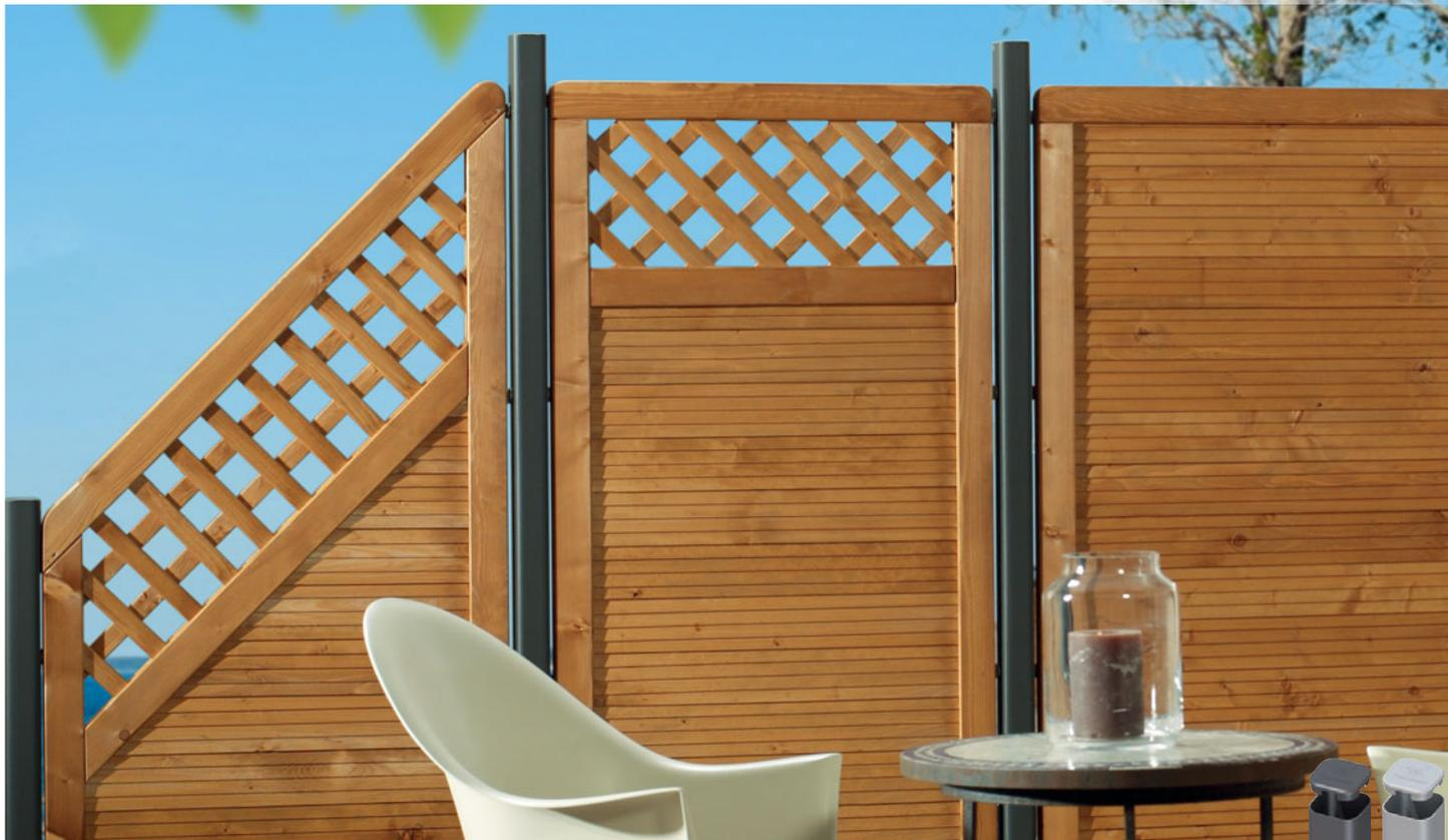
Metallpfosten: Längen 105 und 195 cm zum Aufdübeln mit angeschweißter Bodenplatte (80 x 160 mm) für vier Schrauben.
